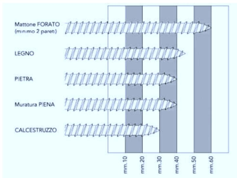
La lunghezza totale della vite, sarà individuata aggiungendo lo spessore del controtelaio e dello spazio tra controtelaio e muro.
