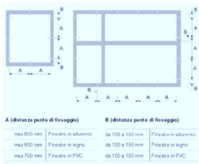
Il fissaggio del controtelaio (se previsto) alla muratura deve essere realizzato:
