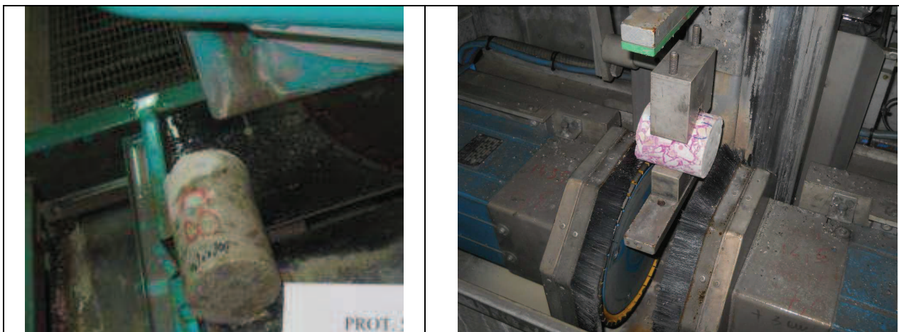
Figura 4. Fasi di taglio e rettifica delle carote.
