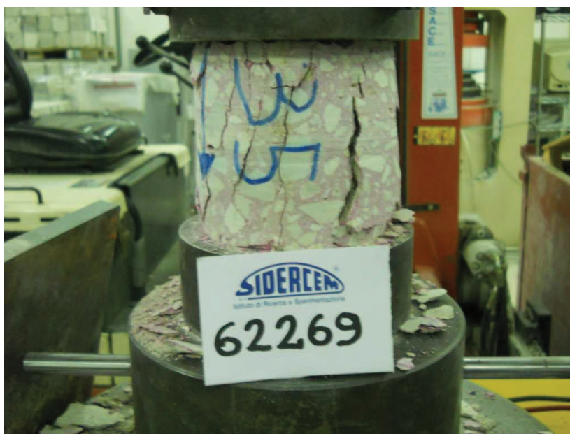
Figura 5. Fase di rottura delle carote.
