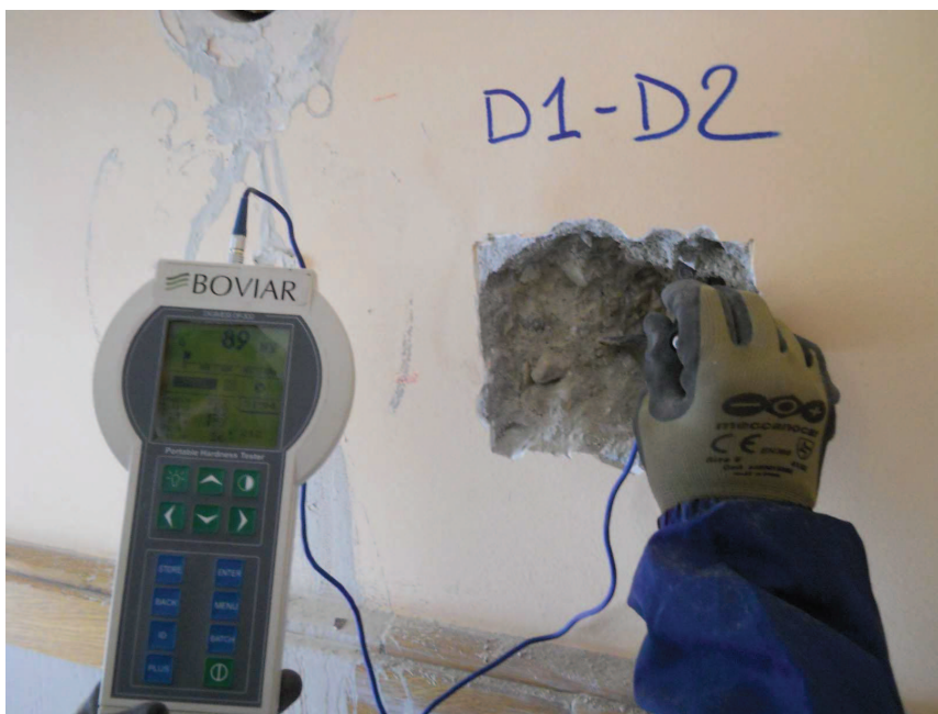
Figura 1. Misura della durezza in situ.
