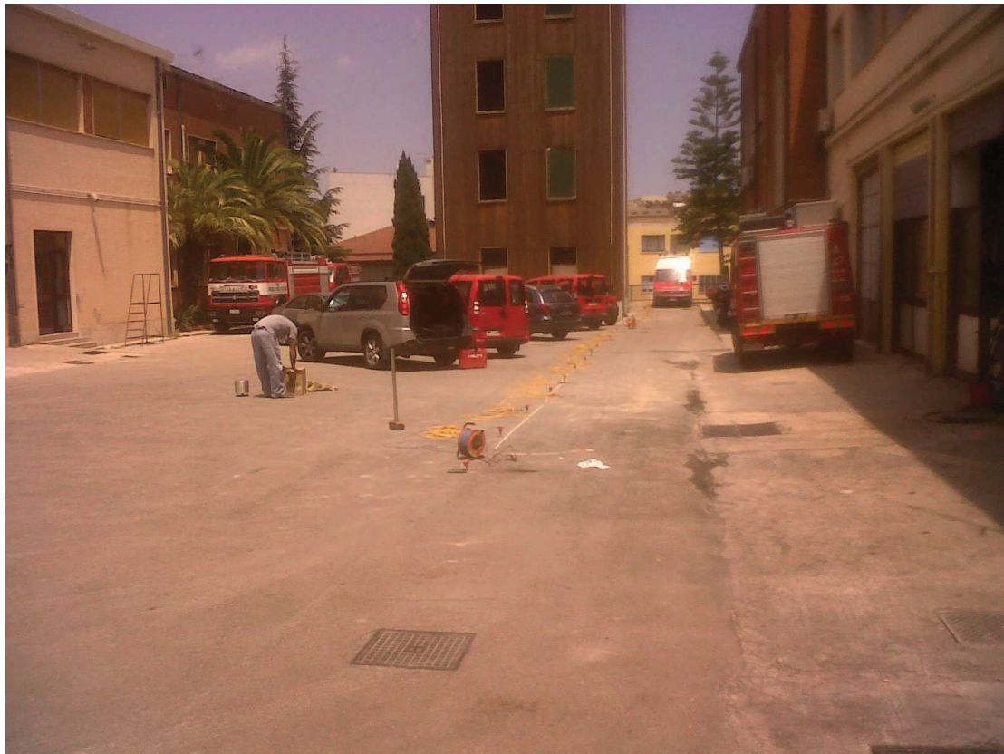
Fig. 1 Foto Cantiere- Linea sismica onde superficiali di Rayleigh – Allineamento attivo e passivo Punto di misura microtremore
