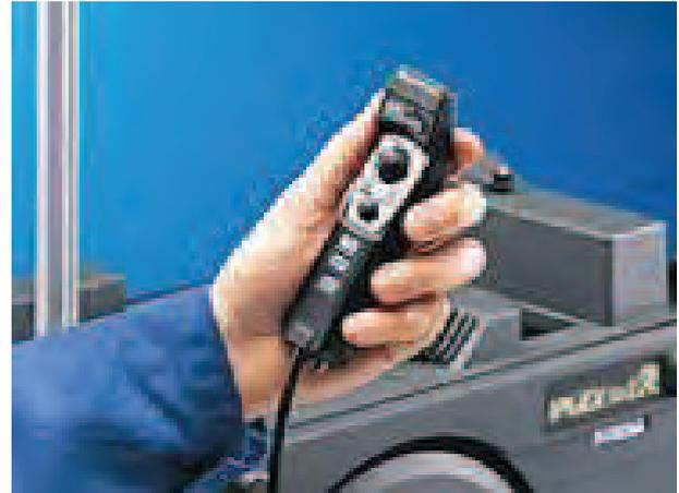
Figura 5-3 Joystick che permette la movimentazione della telecamera
