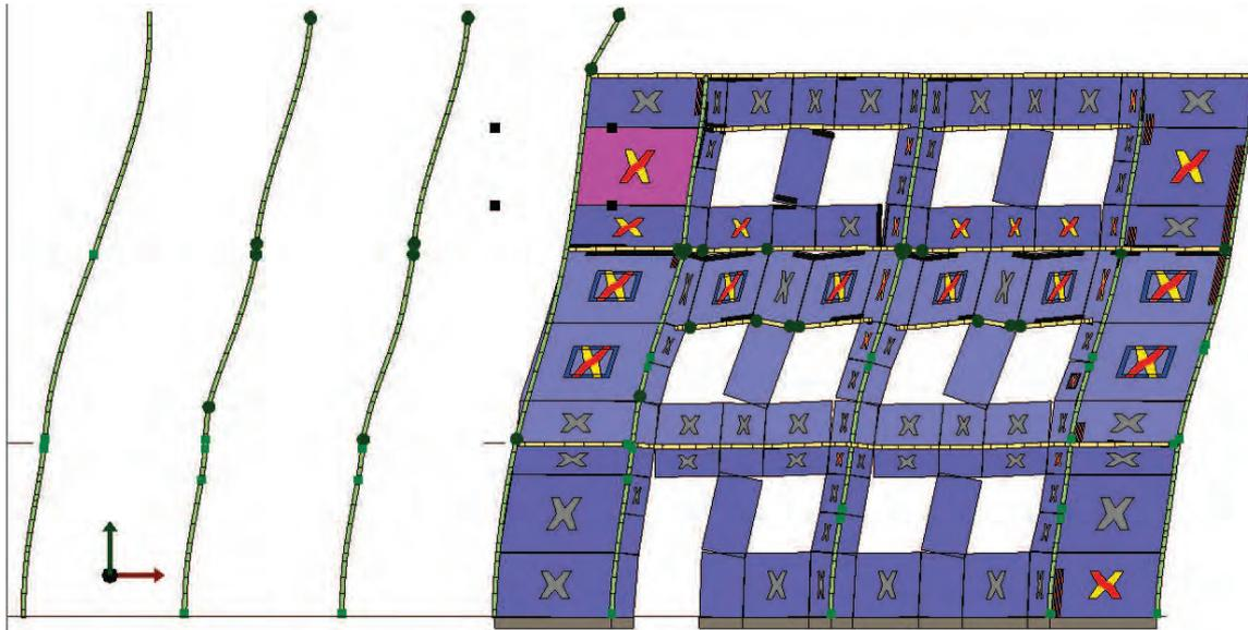
Figura 51: Analisi in direzione +x e carico proporzionale alle masse: deformata a collasso della parete 2.
