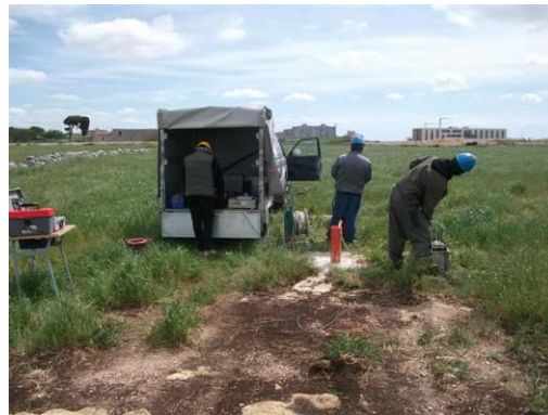
Centro Risvegli Ibleo: Misure sismiche in foro DH1
