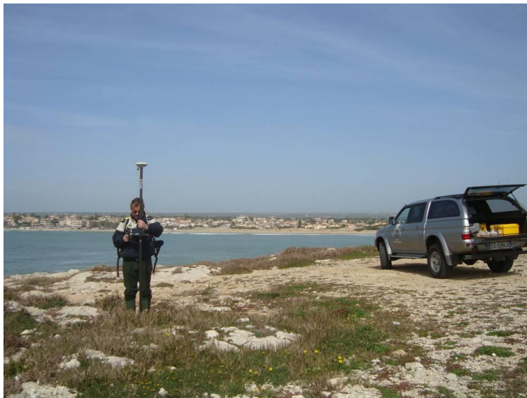
Fase di rilievo topografico relativo a Intervento di salvaguardia di tratti di litorale compresi tra Sampieri e Punta Regilione nei territori dei comuni di
