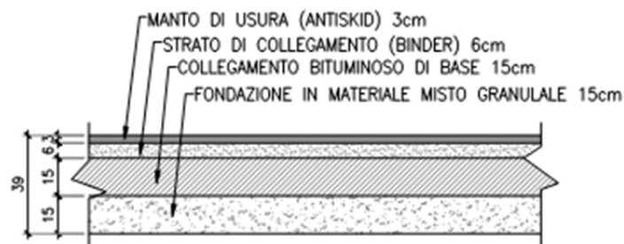
Figura 3. Pacchetto pavimentazione asse principale.
