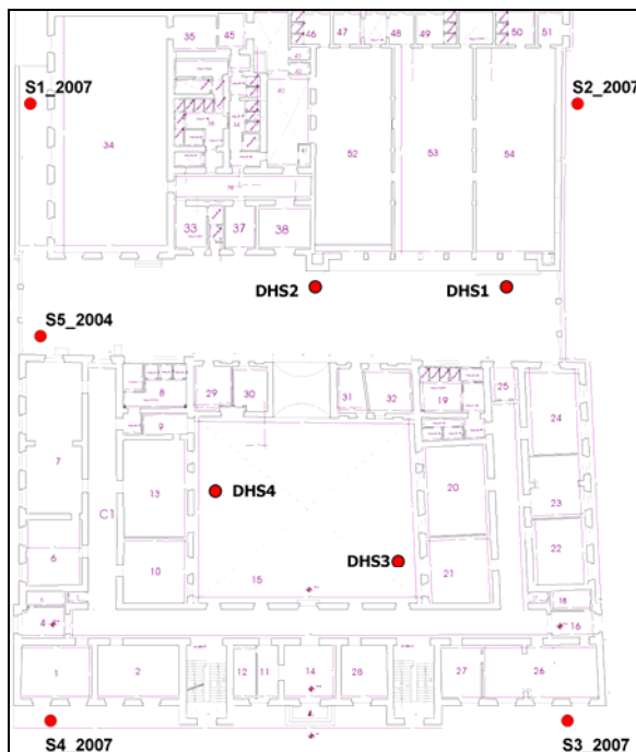
Ubicazione perforazioni Sx e misure sismiche in foro DHSx
