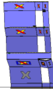
Analisi "Pushover -X Massa - e". Configurazione della parete 25 in corrispondenza della capacità relativa allo stato limite SLV (passo 45).
