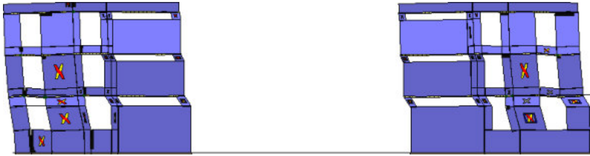
Analisi "Pushover -X Massa". Configurazione della parete 26 in corrispondenza della capacità relativa allo stato limite SLV (passo 45).
