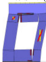
Analisi "Pushover +Y Massa - e". Configurazione della parete 22 in corrispondenza della capacità relativa allo stato limite SLV (passo 52).
