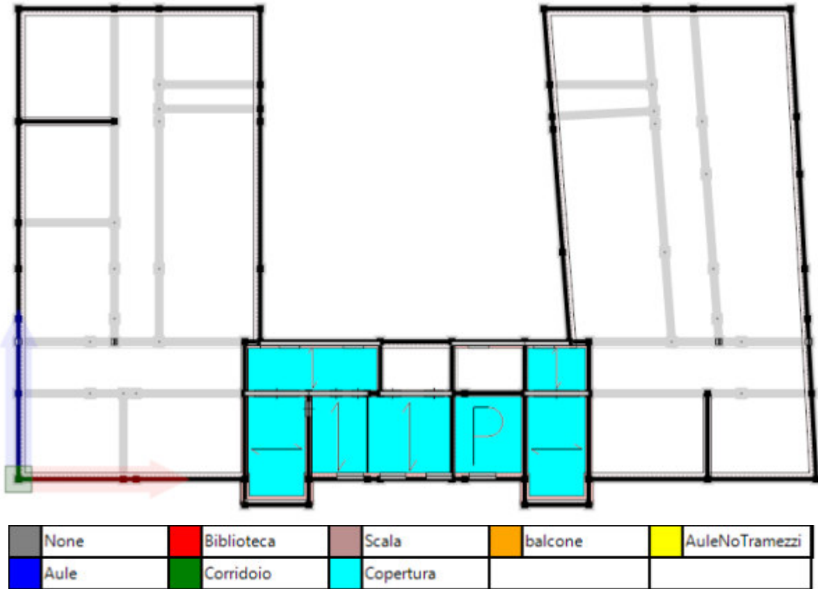
Pianta a quota 1910 cm: carichi di area applicati ai solai.
