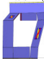
Analisi "Pushover +Y Massa + e". Configurazione della parete 22 in corrispondenza della capacità relativa allo stato limite SLV (passo 45).
