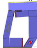
Analisi "Pushover -Y Acc". Configurazione della parete 30 in corrispondenza della capacità relativa allo stato limite SLV (passo 95).
