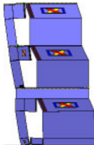
Analisi "Pushover -X Acc". Configurazione della parete 25 in corrispondenza della capacità relativa allo stato limite SLV (passo 338).
