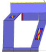
Analisi "Pushover +Y Massa + e". Configurazione della parete 29 in corrispondenza della capacità relativa allo stato limite SLV (passo 72).
