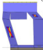
Analisi "Pushover +Y Massa - e". Configurazione della parete 30 in corrispondenza della capacità relativa allo stato limite SLV (passo 82).
