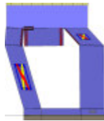
Analisi "Pushover +Y Massa + e". Configurazione della parete 30 in corrispondenza della capacità relativa allo stato limite SLV (passo 72).
