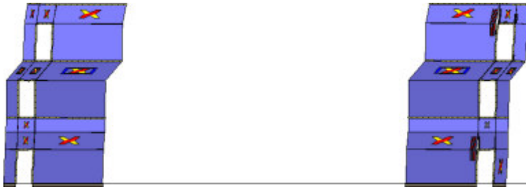
Analisi "Pushover +X Acc". Configurazione della parete 25 in corrispondenza della capacità relativa allo stato limite SLV (passo 328).
