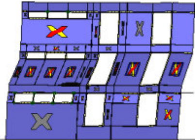
Analisi "Pushover +X Massa + e". Configurazione della parete 26 in corrispondenza della capacità relativa allo stato limite SLV (passo 83).
