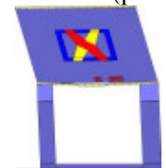
Analisi "Pushover -X Acc". Configurazione della parete 37 in corrispondenza della capacità relativa allo stato limite SLV (passo 299).
