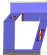
Analisi "Pushover +Y Massa - e". Configurazione della parete 29 in corrispondenza della capacità relativa allo stato limite SLV (passo 82).
