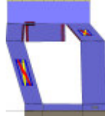
Analisi "Pushover +Y Acc + e". Configurazione della parete 30 in corrispondenza della capacità relativa allo stato limite SLV (passo 255).
