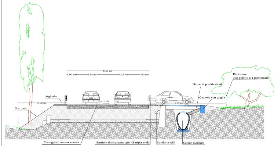
Sezione tipo: innesto canale esistente-canale in progetto
